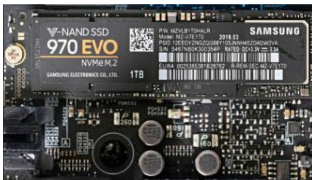
Der Einbau einer M.2-SSD ist sehr einfach. Schwieriger ist es oft, den Steckplatz zu finden – da hilft ein Blick ins Handbuch der Hauptplatine.
