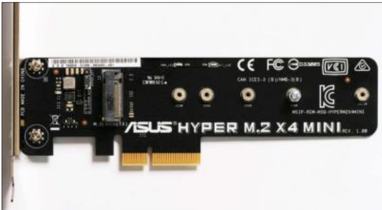
Mehr Tempo für Schreibtisch-PCs: Mit einer Adapterkarte lassen sich schnelle NVMe-SSDs auch in PCs einbauen, denen ein passender Steckplatz auf der Hauptplatine fehlt.
