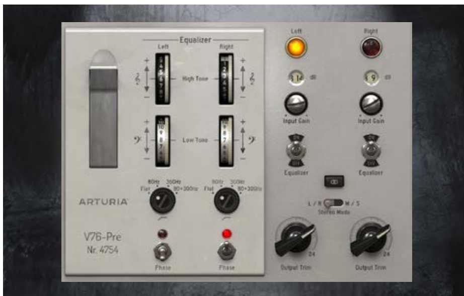
Der V76-Pre verfügt über Pegelregler für Bässe und Höhen, sowie einen vierstufigen High-Pass Schalter. Auch hier hat man an einen Bypass für den EQ gedacht (Mitte rechts).
