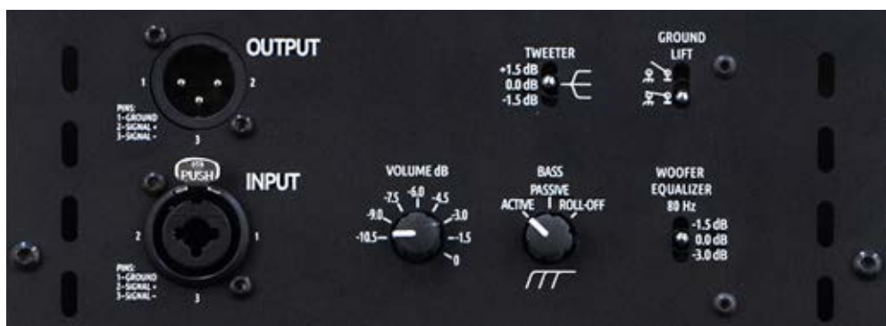
Die Rückseite bietet den Loop Through Ausgang (oben links), sowie Regler für die Eingangsempfindlichkeit und Bass Management (Mitte unten). Per Kippschalter kann man den Pegel für Hochtöner (oben Mitte) und Mittel-/Tieftöner (unten rechts) einstellen.
