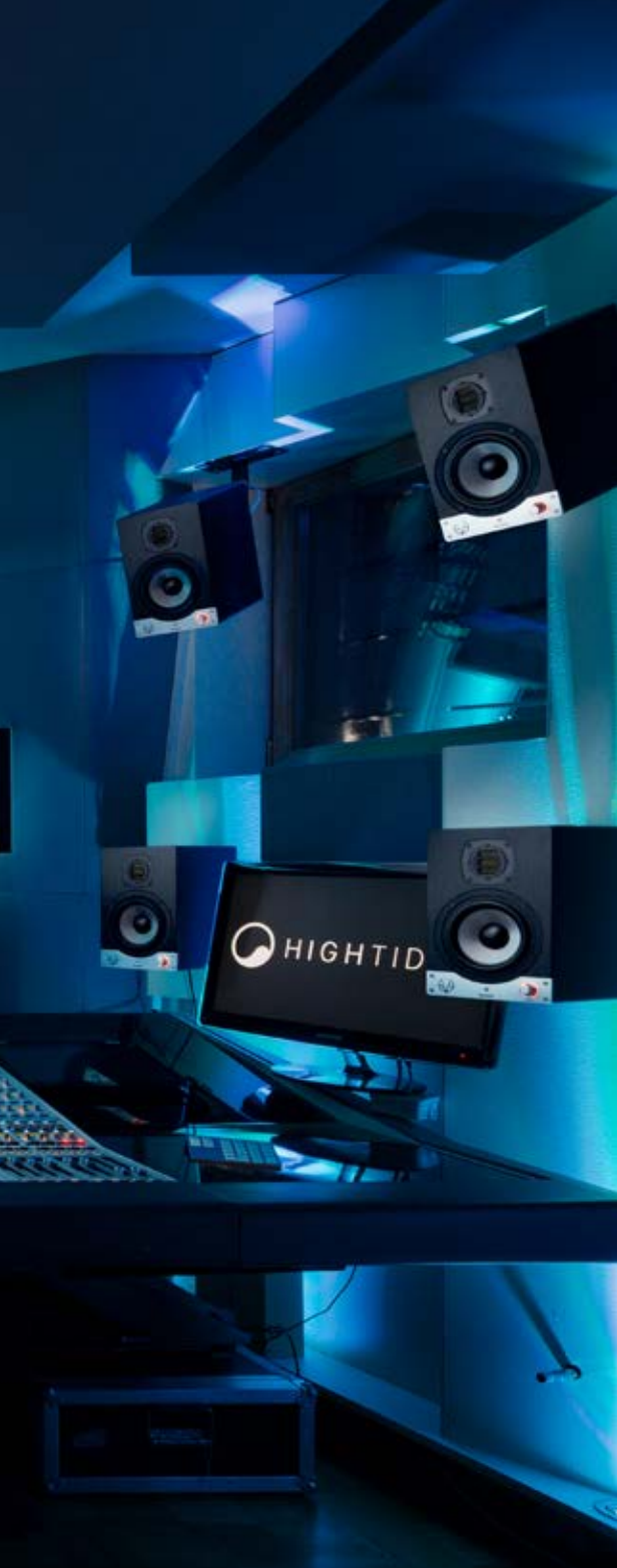
Regie B mit der Sony Oxford R3 Konsole, Eve Audio SC408 Main Abhöre und 28.1 SSW System mit Eve Audio SC205 und TS112. Fotograf: Simon Wegener
