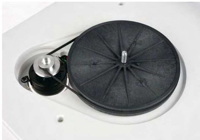
Der Subteller, bei dem penibelst auf Einhaltung der extrem geringen Toleranzen geachtet wird, entkoppelt den Teller vom Motor.
