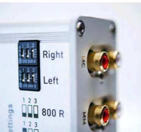
Sechs MC-Lastimpedanzen zwischen 100 und 800 Ohm sind wählbar.
